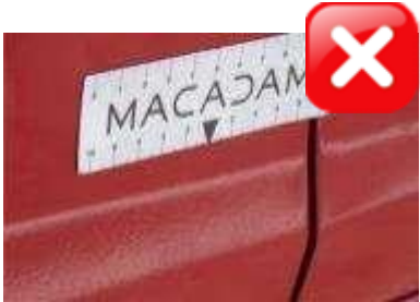
Retouches ou travaux de peinture ayant entraîné des coulures ou avec un aspect granuleux, irrégulier...
